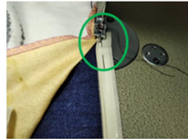
**3** Colocamos el "puente" del prensa telas justo por encima de los dientes.
