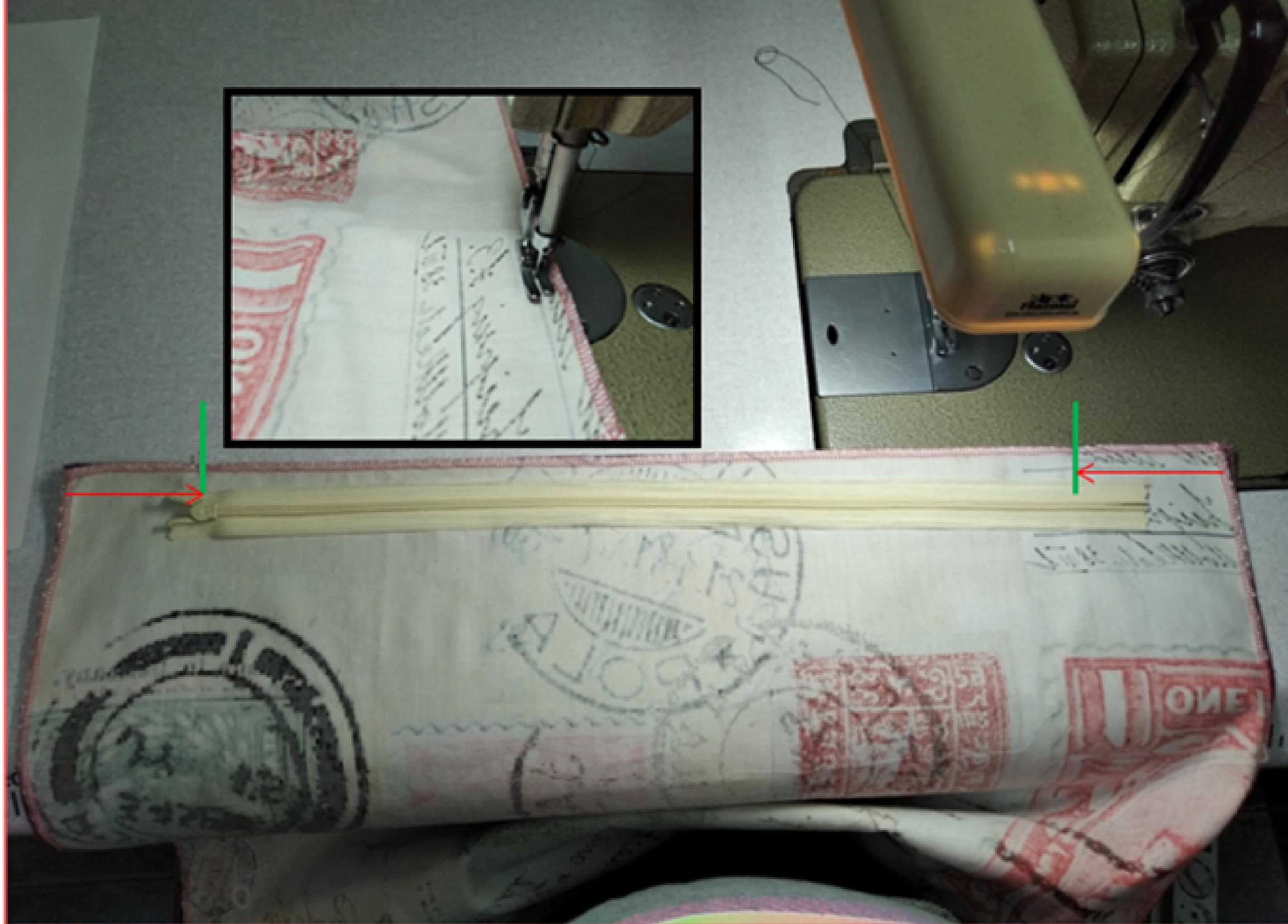
Fijaros bien la foto, hay que coser con el prensatelas normal solo hasta la línea verde (por el principio y por el final).
