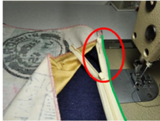
**2** Colocamos borde de cremallera con borde de tela (sujetamos con un alfiler).
